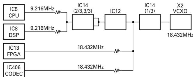
**Fig. 10 Clock diagram**
